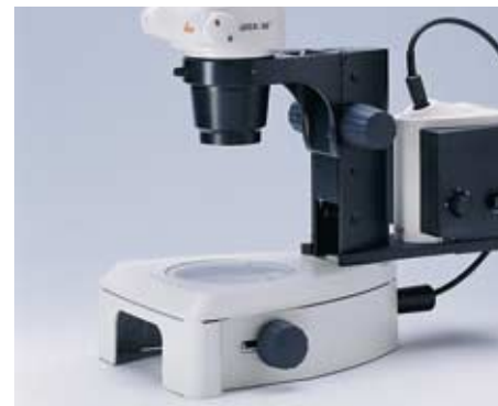
Base de diascopia y conductor de luz universal para iluminación diascópica oblicua
